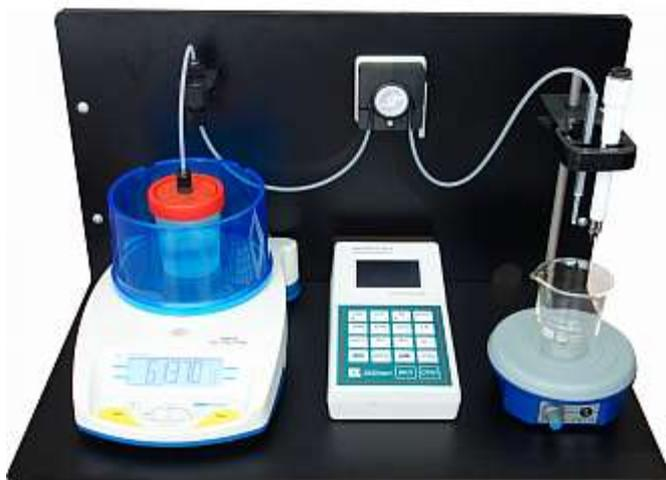
**Титрион-1/1А** Высокоточное амперометрическое и потенциометрическое титрование.
