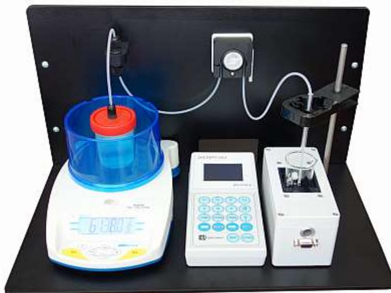
**Титрион-3А** Высокоточное фотометрическое титрование.
