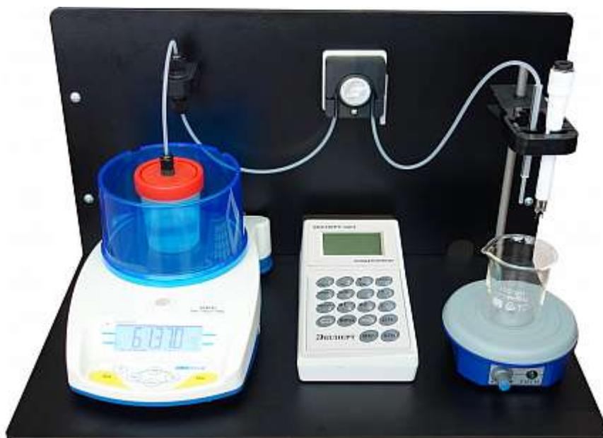
**Титрион-2А** Высокоточное кондуктометрическое титрование.
