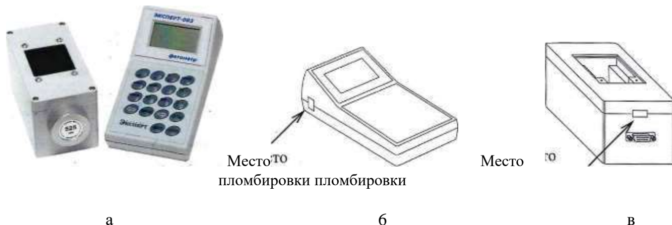
Рисунок 1 — Внешний вид фотометра ЭКСПЕРТ-003 (а), места пломбировки измерительного преобразователя (б) и фотометрической ячейки (в).
