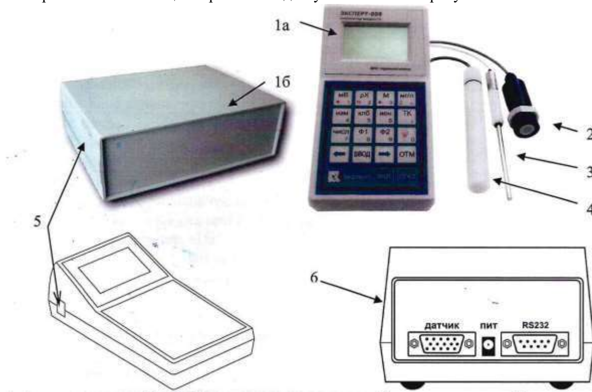
1 — измерительный преобразователь в переносном (а) и стационарном (б) исполнении; 2 — оптический датчик; 3 — датчик температуры; 4 —
