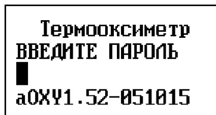
В нижней строке отобразится текущая версия программного обеспечения при работе в режиме «Термооксиметр», например «aOXU1.52-051015». В месте ввода пароля появится указатель в виде мигающего прямоугольника. Введите пароль, набрав число «271», и нажмите кнопку
