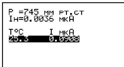
Нажмите кнопку **ИЗМ 4**. Начнётся измерение значения тока. При этом в правом верхнем углу дисплея отобразится показание таймера, а в выделенной строке таблицы – измеряемое значение тока:
