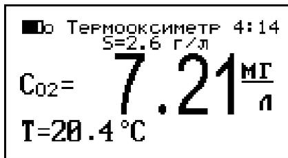
При выключении режим измерения с поправкой на солёность автоматически отключается. Для отключения режима во время измерения установите величину солёности равной 0.
