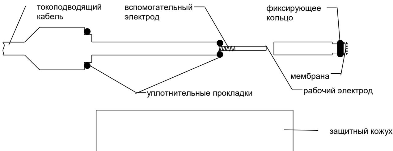
В корпус из оргстекла вклеен электродный узел с дисковым рабочим электродом и вспомогательным электродом. На корпус датчика навинчивается колпачок из оргстекла, заполняемый рабочим электролитом, на торце которого с помощью резинового фиксирующего кольца крепится мембрана. При транспортировке и хранении на корпус навинчивается защитный кожух, заполняемый дистиллированной водой.
