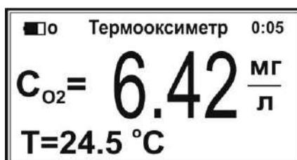
В первой строке сверху отобразятся символ состояния заряда аккумулятора, название текущего режима измерения **«Термооксиметр»** и показание таймера. Во второй строке крупным шрифтом отобразится результат измерения массовой концентрации растворённого кислорода. В нижней строке отобразится результат измерения температуры анализируемой среды.
