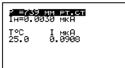
В верхней строчке отобразится значение атмосферного давления, введённого пользователем при последней градуировке. Во второй строчке – значение тока, измеренное для раствора с нулевой концентрацией растворённого кислорода. Ниже отобразится результат измерения значения тока для раствора, насыщенного кислородом воздуха при известной температуре, в данном случае при 25 °С.
